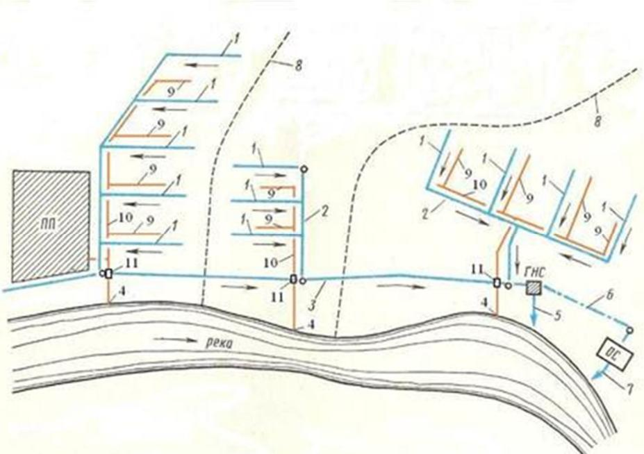
Схема совмещенной централизованной системы водоотведения населенного пункта.
