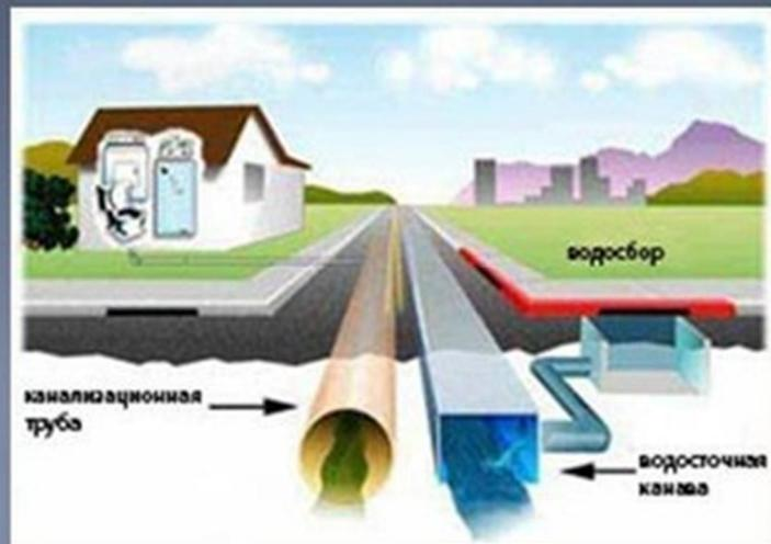
Схема раздельной централизованной системы водоотведения населенного пункта.
